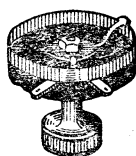
Рис. 22. Внешний вид и обозначение переменного сопротивления
